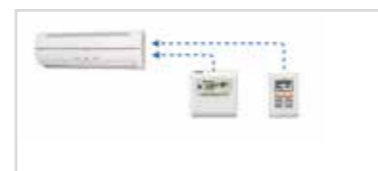
Con comando a distanza via cavo
